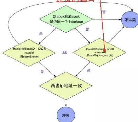
而 `connect()` 系统调用在进行随机端口的选择时，是走 `__inet_check_established` 判断可用性的，其中不但允许复用存在 `TIME_WAIT` 连接的端口，还针对存在 `TIME_WAIT` 的连接的端口进行了如下判断比较，以确定是否可以复用：
