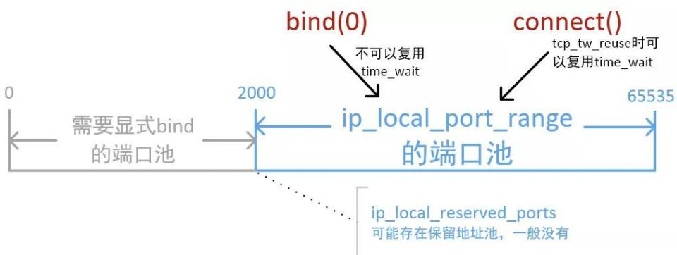
于是答案就明了了，`bind(0)` 和 `connect()` 冲突了，`ip_local_port_range` 的池子里被 50W 个 `connect()` 遗留的 `time_wait` 占满了，导致 `bind(0)` 失败。知道了原因，修复方案就比较简单了，将 `bind(0)` 改为 `bind` 指定 port，然后在应用层自己维护一个池子，每次从池子中随机地分配即可。
