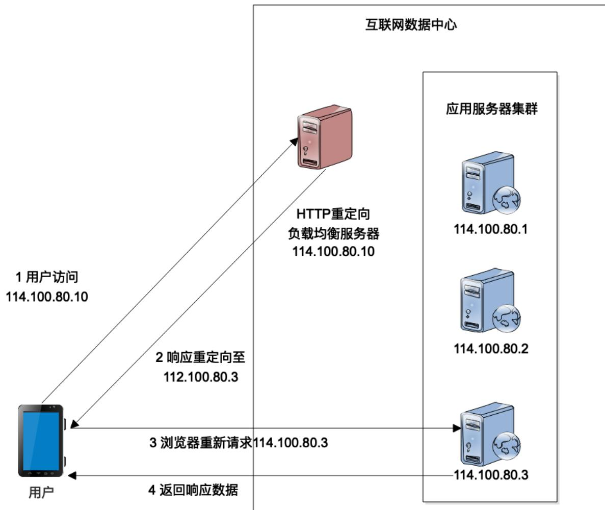
这种负载均衡实现方法比较简单，如果是用 Java 开发的话，只需要在 Servlet 代码中调用响应重定向方法就可以了。在简化的情况下，只需要不到十行代码就可以实现一个 HTTP 重定向负载均衡服务器。
