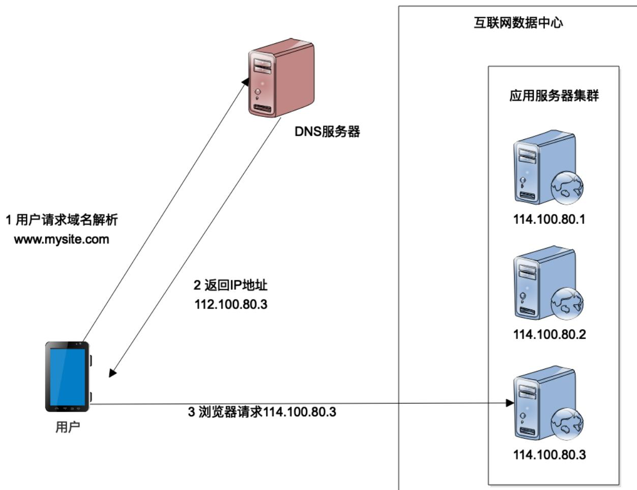
从上面的架构图可以看到，DNS 负载均衡和 HTTP 重定向负载均衡似乎很像。那么 DNS 会不会有性能问题和安全性问题呢？
