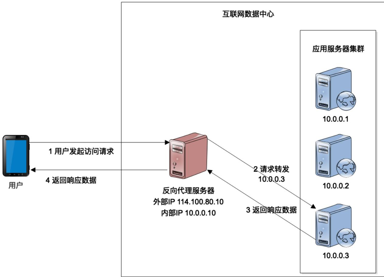
反向代理服务器是工作在 HTTP 协议层之上的，所以它代理的也是 HTTP 的请求和响应。作为互联网应用层的一个协议，HTTP 协议相对来说比较重，效率比较低，所以反向代理负载均衡通常用在小规模的互联网系统上，只有几台或者十几台服务器的规模。
