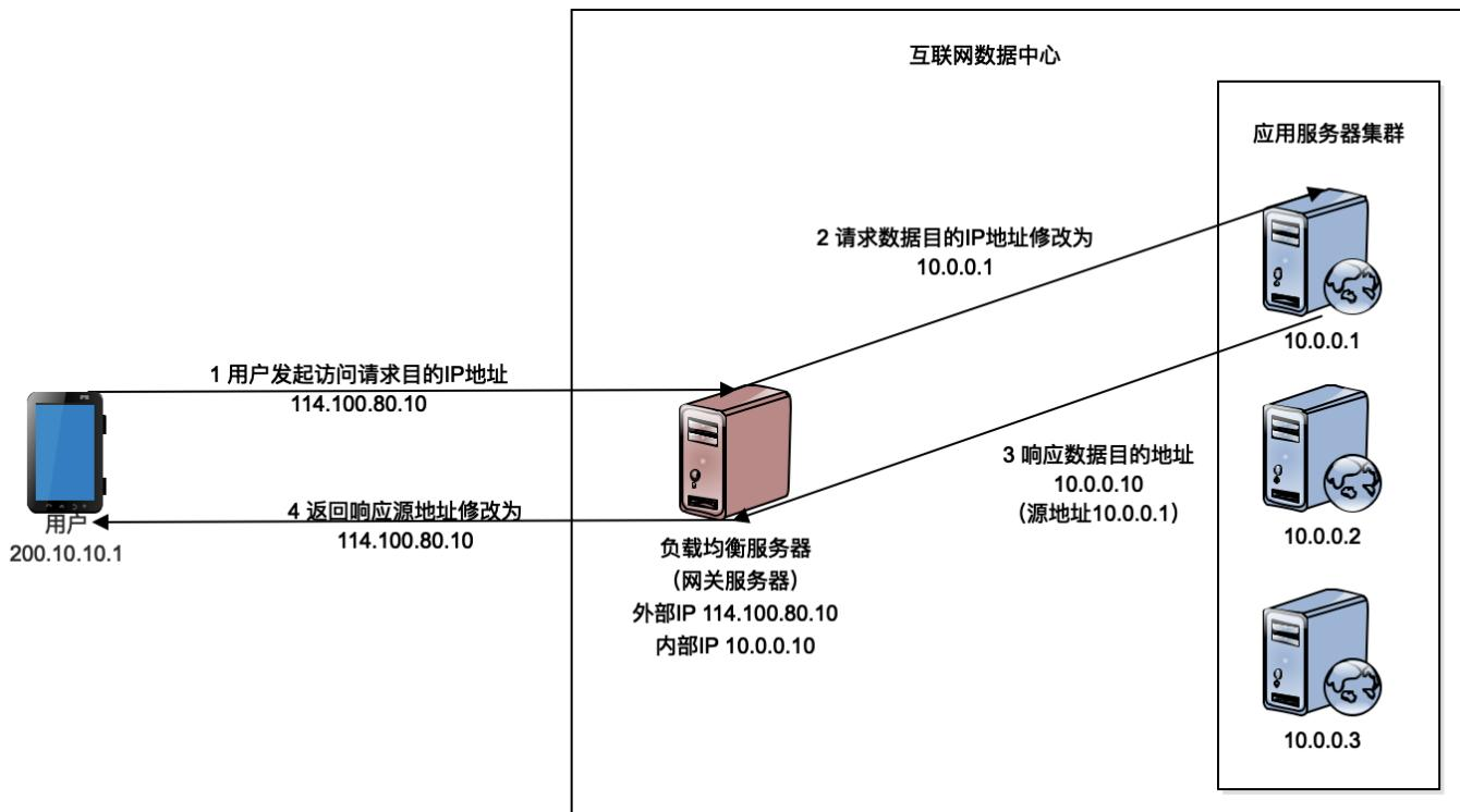
IP 负载均衡不需要在 HTTP 协议层工作，可以在操作系统内核直接修改 IP 数据包的地址，因此，效率比应用层的反向代理负载均衡高得多。但是它依然有一个缺陷，不管是请求还是响应的数据包，都要通过负载均衡服务器进行 IP 地址转换，才能够正确地把请求数据分发到应用服务器，或者正确地将响应数据包发送到用户端程序。请求的数据通常比较小，一个 URL 或者是一个简单的表单，但是响应的数据不管是 HTML 还是图片，或者是 JS、CSS 这样的资源文件通常都会比较大，因此负载均衡服务器会成为响应数据的流量瓶颈。
