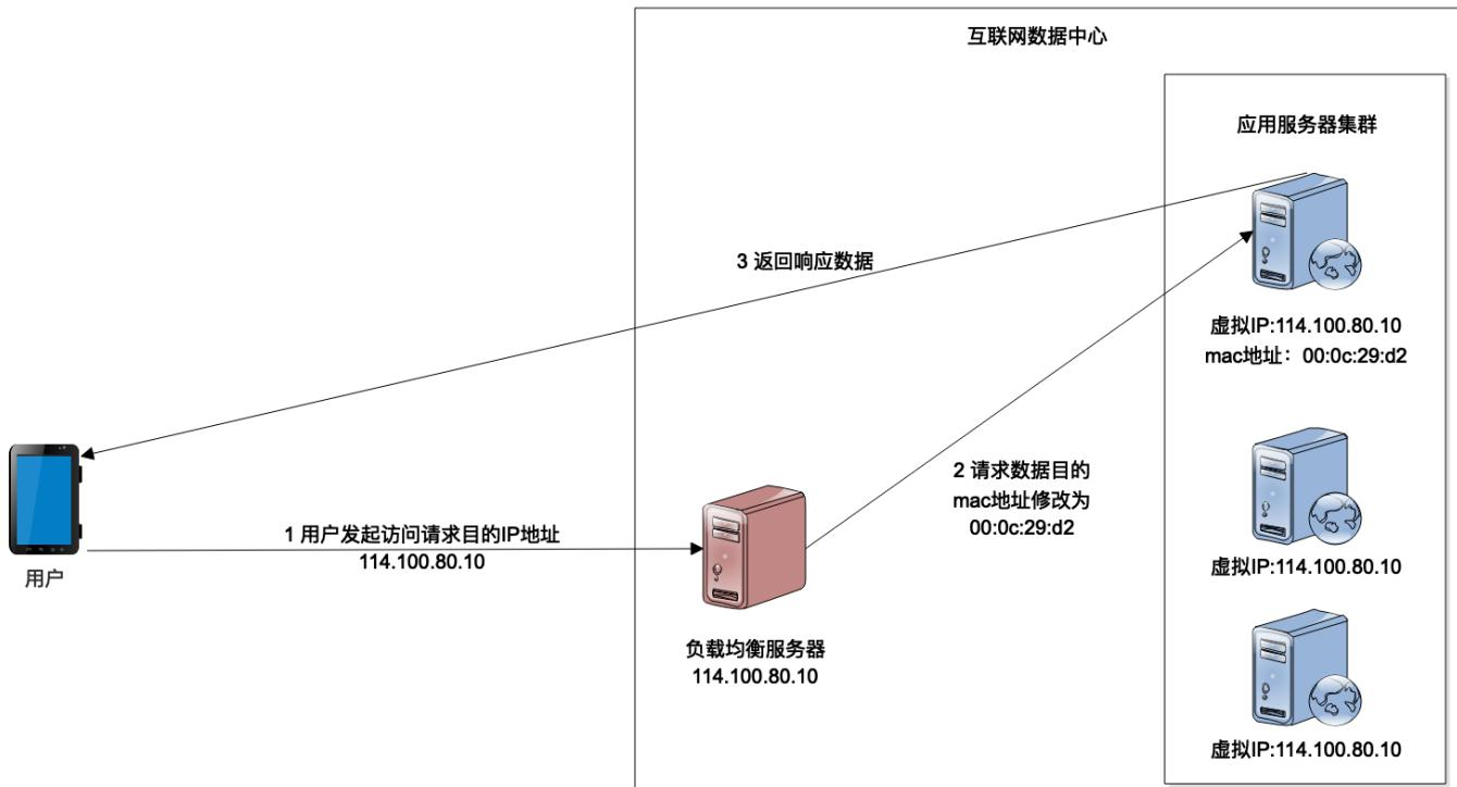
链路层负载均衡避免响应数据再经过负载均衡服务器，因而可以承受较大的数据传输压力，所以，目前大型互联网应用基本都使用链路层负载均衡。
