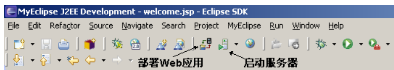
图 3.13 在 Eclipse 中部署 Web 应用和启动服务器的按钮
