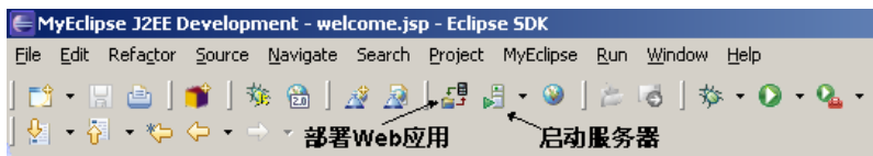
图 3.13 在 Eclipse 中部署 Web 应用和启动服务器的按钮
