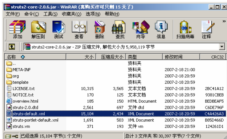
图 3.21 struts2-core-2.0.6.jar 压缩文件的文件结构
