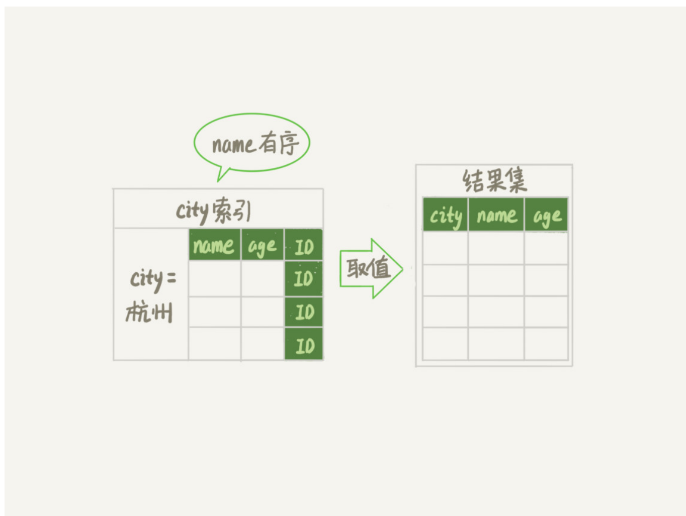
图 10 引入 (city,name,age) 联合索引后，查询语句的执行流程
